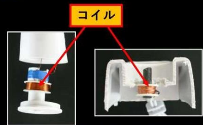
電動歯ブラシの断面 無接点充電器の断面
